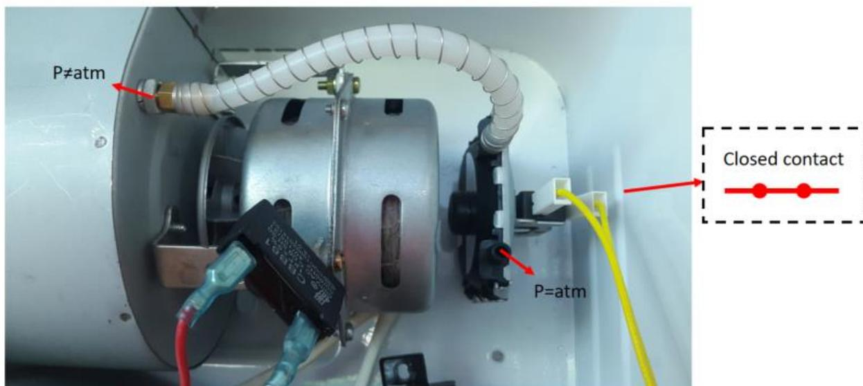
Figura 17 – Funcionamiento del presostato – efecto Venturi
